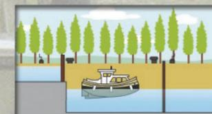
4 : Le niveau de l'eau dans le sas où se trouve le bateau est identique au niveau de l'eau dans le tronçon suivant.
